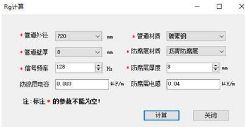
可以通过系统主菜单“工具”子菜单中“Rg 计算”项调出该输入框。其中，防腐层 电容和防腐层电感可以做留空处理，其他参数必须提供。点击“计算”按钮，系统得出于当前测量数据的外防腐层绝缘电阻率  $R_g$ ：
